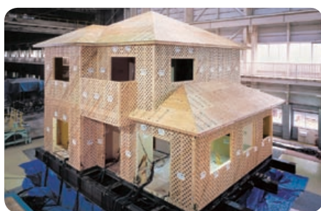
実物大の構造モデルによる耐震試験
